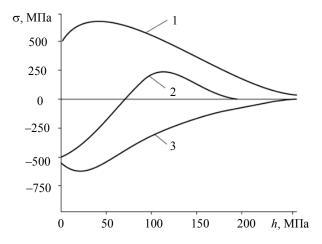
Рис. 2. Распределение остаточных напряжений σ(h) в стали 20X13 после обработки: 1 – ручное шлифование на станке ЛШ-95 (Германия); 2 – шлифование лентой на станке Metabo (Германия); 3 – фрезерование на станке Forest (Германия)
