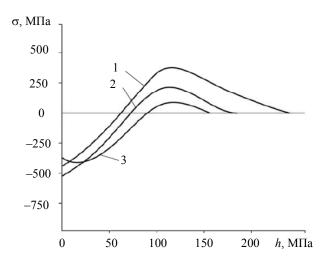
Рис. 1. Влияние режимов шлифования на остаточные напряжения  $\sigma(h)$ : 1 – скорость резания v=10 м/с; подача S=0,3 м/с; давление инструмента на обрабатываемую поверхность P=100 H; 2 – v=20 м/с; S=0,2 м/с; P=150 H; 3 – v=40 м/с; S=0,1 м/с; P=200 H
