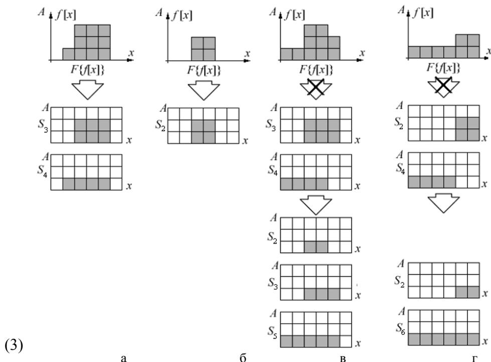
Рис. 1. Допустимые и недопустимые варианты конфигурации элементов декомпозиции по БПВ:  $f[x]$  – исходные сигналы с амплитудой  $A$ ;  $S_k$  – спектральный элемент декомпозиции, полученный выделением всплесков протяженностью  $k$
