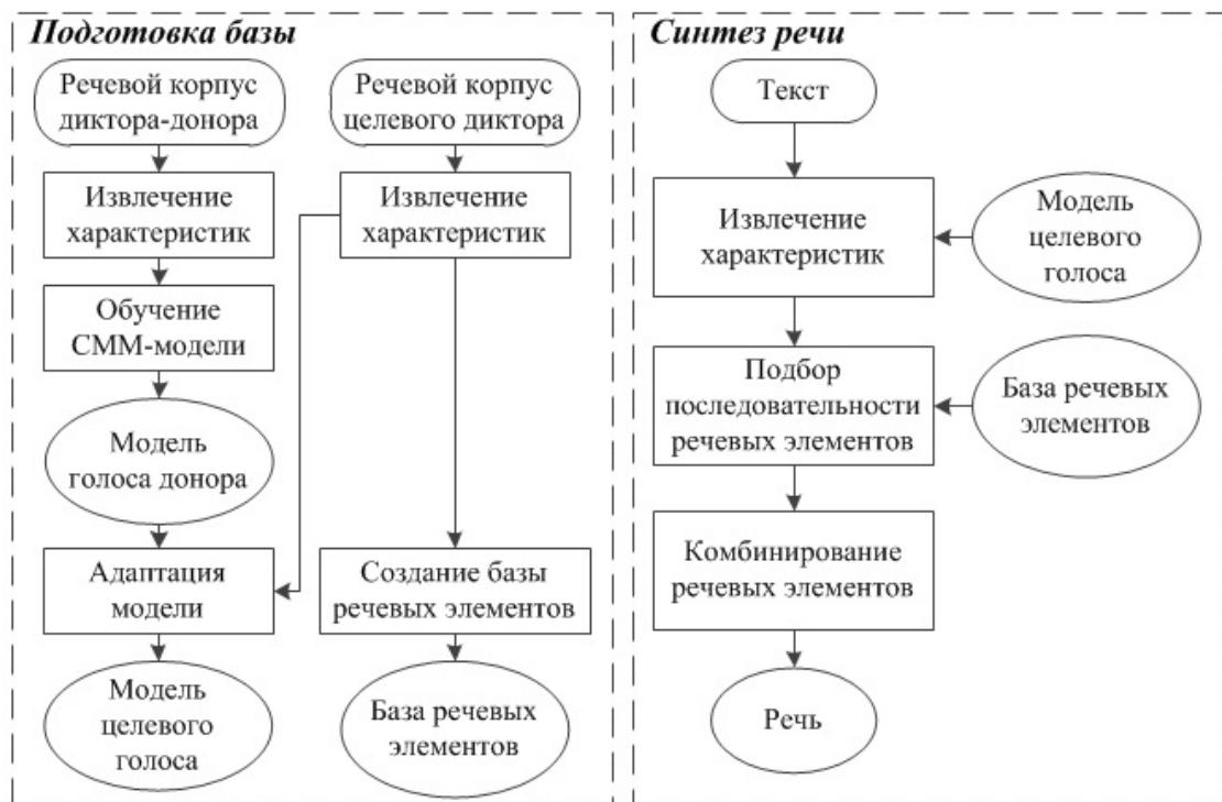
Рис. 1. Структура гибридной системы синтеза речи
